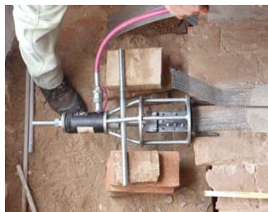
Il martinetto a riposo prima dell'inizio della prova.
