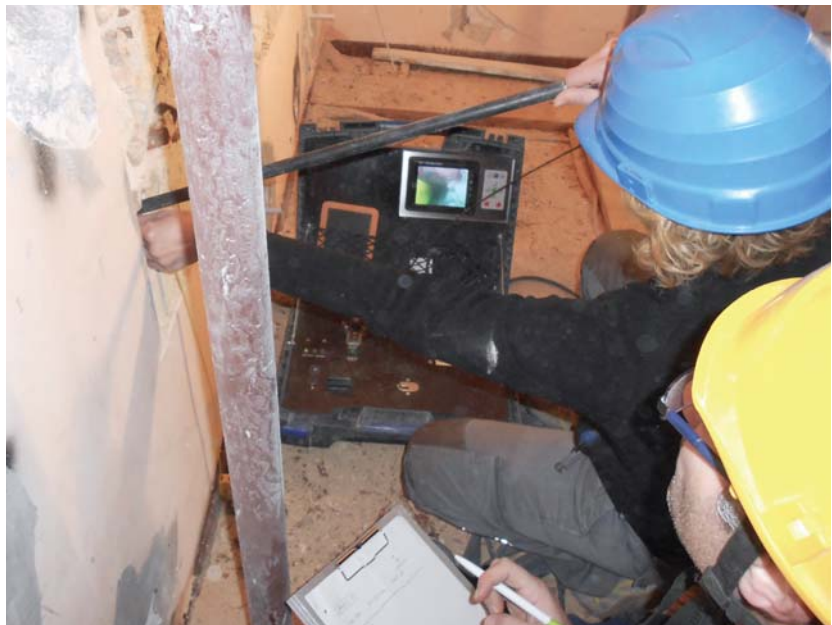
Realizzazione della video-endoscopia.
