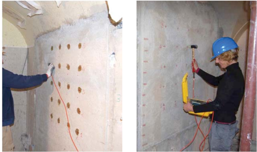
Indagine sonica post-consolidamento sui due lati della stessa parete.
