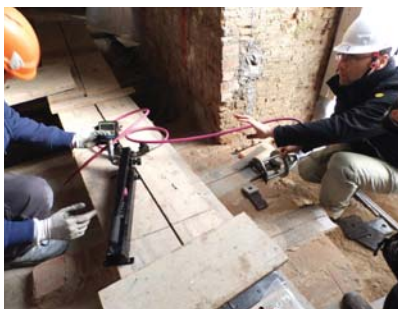
La pompa e il martinetto durante le fasi preparatorie.
