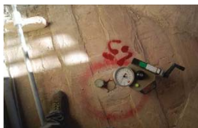
Prova di aderenza strappo normale sul campione di fibra di acciaio.
